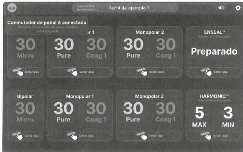
5.1 Pantalla del conmutador de pedal correctamente conectado: configuración del módulo de energía doble
